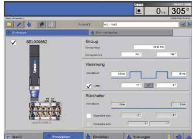
**Programmazione diretta dei moduli di processo CN attraverso una semplice maschera di immissione nel sistema di comando**
